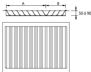
Para calcular el precio de una rejilla de chapa galvanizada con lamas en dos direcciones sumar el precio de las rejillas equivalentes a cada dirección, siendo el sentido de la lama, la cota A de la rejilla (ver la página anterior).
