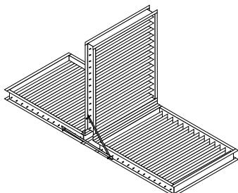
Compuertas de regulación en aluminio montadas en "T". Varias posibilidades de aperturas, en oposición y sincronizadas.
