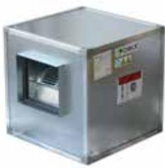
Unidades de ventilación para conductos, con ventilador centrífugo con motor incorporado de rotor externo (RE) ultrasilencioso, perifería de aluminio, aislamiento termo acústico de 15 mm de espesor y tapas intercambiables.
