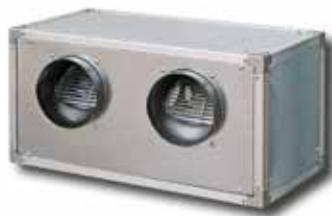
Unidades de ventilación para conductos, con dos ventiladores centrífugos en paralelo con motor incorporado de rotor externo (RE) ultrasilencioso, perifería de aluminio, aislamiento termoacústico de 15 mm de espesor.
