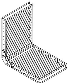
Compuertas de regulación en aluminio montadas en "L", a 90º. Posibilidad de apertura en oposición o sincronizada.
