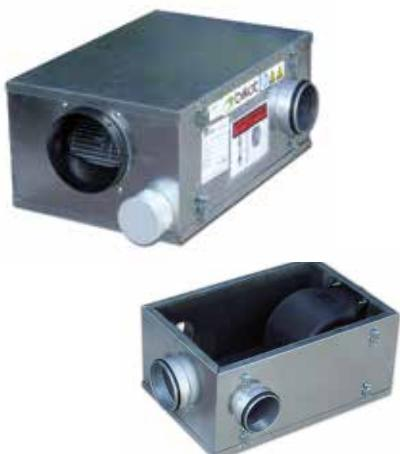
Unidades de ventilación de baja silueta (BS) para conductos, con tres embocaduras de aspiración, con ventilador centrífugo con motor incorporado de rotor externo (RE) ultrasilencioso, aislamiento termo acústico de 15 mm de espesor y cierre rápido.
