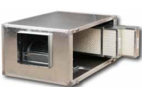
Unidades de filtración para conductos, acorde al RITE, con ventilador centrífugo con motor incorporado, perfilería de aluminio y aislamiento termo acústico de 15 mm de espesor.
