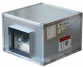
Unidades de ventilación de baja silueta (BS) para conductos, con ventilador centrífugo con motor incorporado, perfilería de aluminio, aislamiento termo acústico de 15 mm de espesor y tapas intercambiables.
