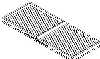
Compuertas de regulación en aluminio montadas en Tándem. Posibilidad de apertura en oposición o sincronizada.
