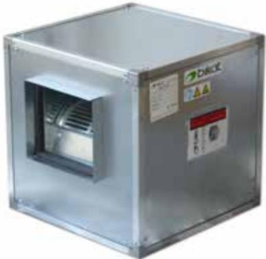
Unidades de ventilación con ventilador centrífugo con motor EC de alta eficiencia incorporado, perifería de aluminio, aislamiento termoacústico de 15mm de espesor y tapas intercambiables. Caudales disponibles desde 2.340 m<sup>3</sup>/h hasta 7.040 m<sup>3</sup>/h.
