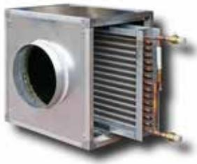
Unidades con baterías de agua fría o caliente para acoplar a unidades de ventilación o recuperadores de calor. Potencias disponibles desde 5,5 kW hasta 81 kW para frío, y desde 8,5 kW hasta 137,2 kW para calor. Caudales desde 500 m<sup>3</sup>/h hasta 10.000 m<sup>3</sup>/h.
