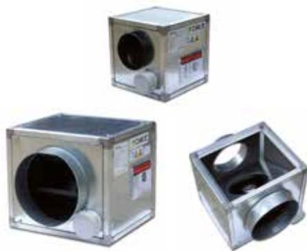
Unidades de ventilación para conductos, con ventilador centrífugo tipo EC con motor incorporado de rotor externo (RE) ultrasilencioso, perfilera de aluminio, aislamiento termo acústico de 15 mm de espesor y tapas intercambiables. Caudales disponibles desde 660 m<sup>3</sup>/h hasta 1.430 m<sup>3</sup>/h.
