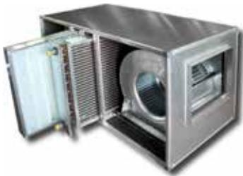
Unidades de ventilación con batería de agua caliente de cobre y aluminio, con etapa de filtración desde G4 hasta F9, periferia de aluminio y aislamiento termo acústico, y ventiladores centrífugos con motor incorporado de doble aspiración y rodete de álabes hacia adelante. Caudales disponibles desde 1.000 m<sup>3</sup>/h hasta 6.000 m<sup>3</sup>/h. Potencias disponibles desde 7 kW hasta 94 kW.
