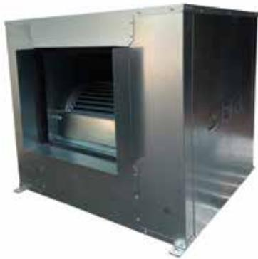
Unidades de ventilación para conductos, con ventilador centrífugo con motor incorporado, en caja de acero galvanizado autoportante, aislamiento termo acústico de 15 mm de espesor. Caudales disponibles desde 1.080 m<sup>3</sup>/h hasta 8.290 m<sup>3</sup>/h.
