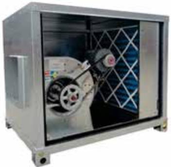
Unidades de filtración para conductos, con motor a transmisión de doble aspiración montado sobre bancada o voluta, perfilería de aluminio y aislamiento termo acústico de 15 o 25 mm de espesor. Caudales disponibles desde 1.000 m<sup>3</sup>/h hasta 50.000 m<sup>3</sup>/h.
