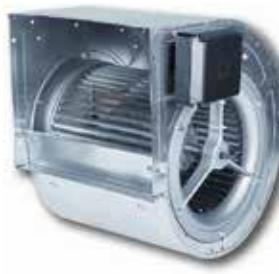
Ventilador centrífugo doble aspiración con motor incorporado, rodamiento de álabes hacia delante, motor de rotor exterior con rodamientos a bolas y protector térmico. Motores:
