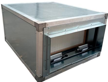
Unidades de filtración absoluta para conducto, con ventilador Plug Fan EC de alta eficiencia, periferia de aluminio anodizado con tapas en acero galvanizado con aislamiento termo acústico de 15 mm de espesor con prefiltrado F7 y filtro HEPA H14 de alta capacidad de filtración.
