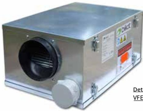
Unidades de filtración de baja silueta para conductos, acorde al RITE, con ventilador Plug Fan EC con motor incorporado de rotor externo ultrasilencioso, en cajas autoportantes de acero galvanizado con aislamiento termo acústico de 25 mm de espesor. Caudales disponibles desde 460 m<sup>3</sup>/h hasta 3.010 m<sup>3</sup>/h.
