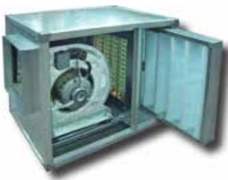
Unidades de ventilación con batería eléctrica de níquel y cromo, con etapa de filtración desde G4 hasta F9, perfilería de aluminio y aislamiento termo acústico, y ventiladores centrífugos con motor incorporado de doble aspiración y rolete de álabes hacia adelante. Caudales disponibles desde 1.000 m<sup>3</sup>/h hasta 6.000 m<sup>3</sup>/h. Potencias disponibles desde 4 kW hasta 20 kW.
