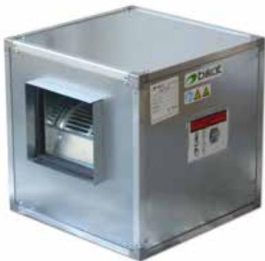
Unidades de ventilación para conductos, con ventilador centrífugo con motor incorporado, perfilería de aluminio, aislamiento termo acústico de 15 mm de espesor y tapas intercambiables.
