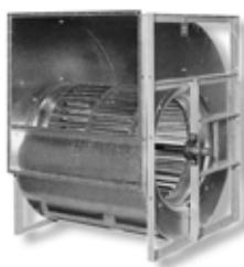
Ventilador centrífugo con rodetes de palas de acción. Fabricado en chapa de acero galvanizado con estructura de refuerzo. Temperatura máxima de trasiego: 60°C.
