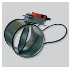
REMP Compuertas motorizadas proporcionales circulares con cuerpo de acero galvanizado y motorización controlada por sonda de CO 2 . El servomotor funciona proporcionalmente a la señal 0-10V enviada por la sonda. Intercalando el módulo BEAS se pueden ajustar las posiciones de apertura mínima y máxima. Se utilizan en los sistemas de ventilación multizona tipo proporcional.
