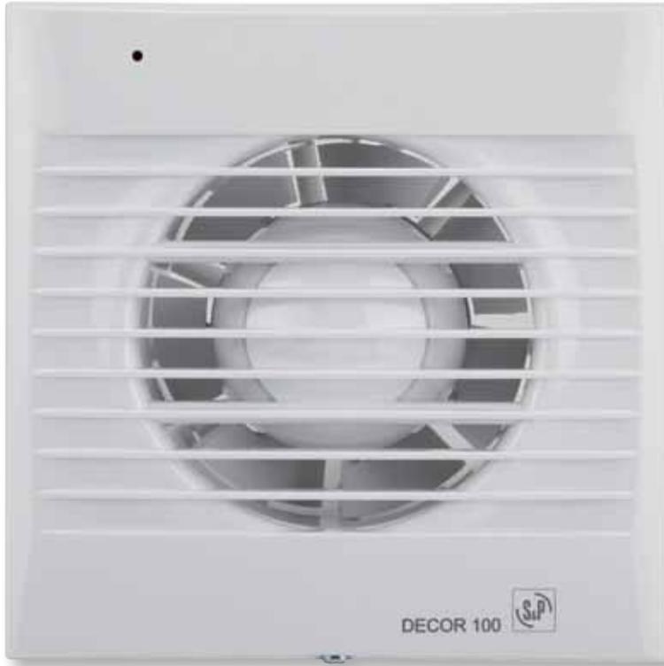
Ventiladores helicoidales extraplano, con caudal aproximado de 100 m<sup>3</sup>/h, compuerta antirretorno incorporada, luz piloto de funcionamiento, motor 230V-50Hz, con rodamientos a bolas (modelos Z), IPX4, Clase II, con protector térmico, para trabajar a temperaturas de hasta 40°C.
