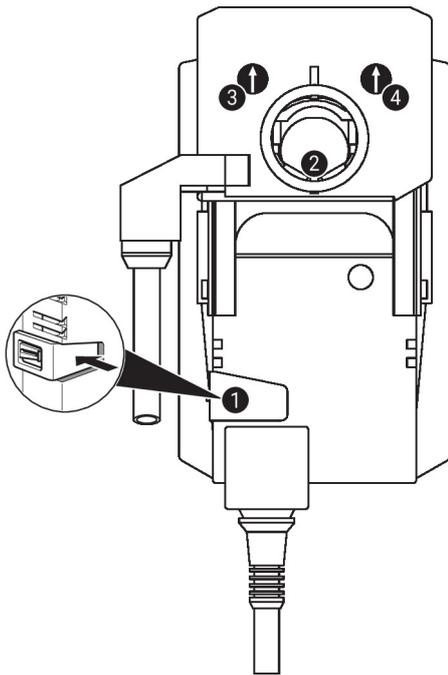
Configuración del contacto auxiliar
